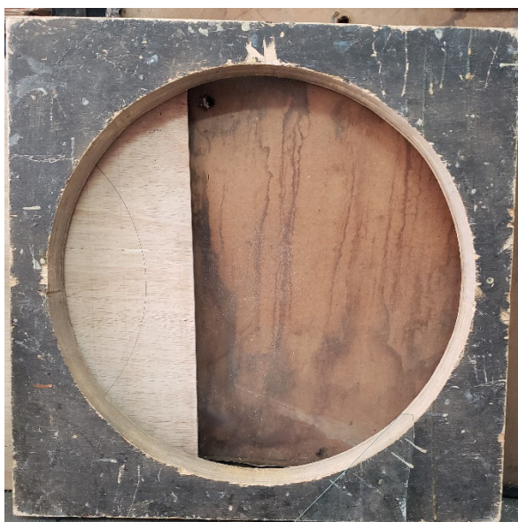
Figura 3: Molde para a fabricação do corpo dos tambores.
