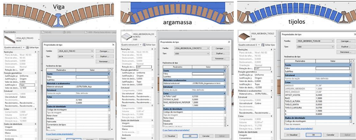
Figura 5 - Perfis personalizados pela família Viga: parametria do elemento construtivo abobadilha
