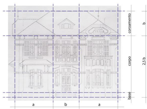
Figura 2 – Marcação dos trimorfismos na fachada principal
