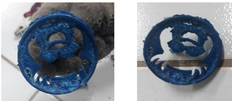
Figura 10 – Resultado do teste de injeção em molde impresso em resina
