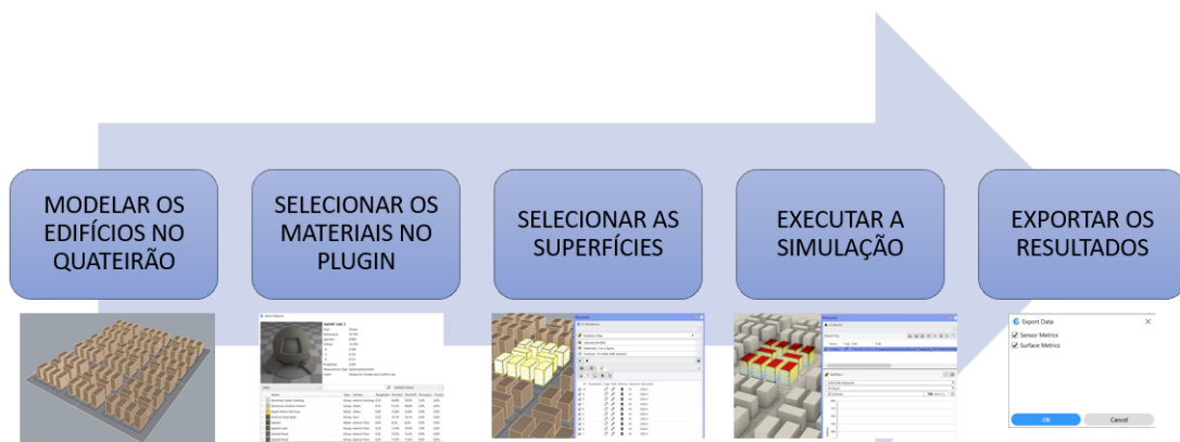
Figura 5 - Workflow para as simulações utilizando Rhinoceros e ClimateStudio
