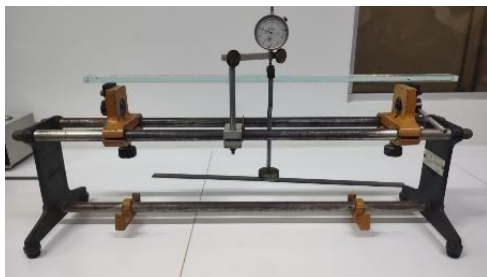
Figura 2. Chapa de vidro na máquina de flexão.
