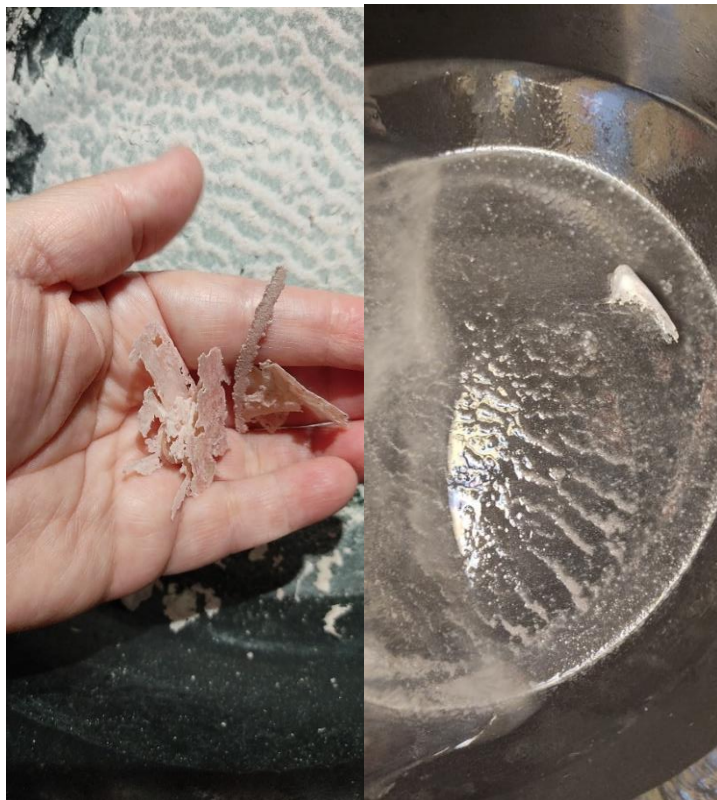
Imagem 20. Detritos restantes da lavagem da peça em água, após a decantação. Todos estes restos estriam no sistema de esgoto se a lavagem tivesse sido feita como indicado nos comerciais. Fonte: da autora, 2022.
