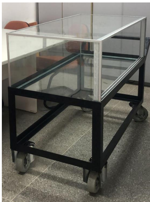
Imagem 2. Sequência do planejamento e construção do tabuleiro-carrinho. Parte superior do tabuleiro. a = 120,6 b = 60,5 c = 40,5 cm.. Fotos: Eriel Araújo
