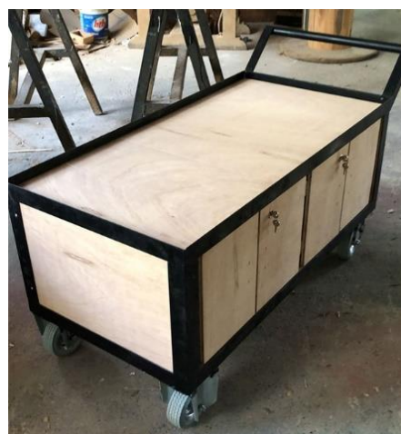
Imagem 2. Sequência do planejamento e construção do tabuleiro-carrinho. Parte superior do tabuleiro. a = 120,6 b = 60,5 c = 40,5 cm.. Fotos: Eriel Araújo
