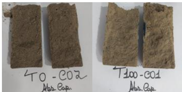
Figura 3 - Corpo de prova T0% e T100% após 72h de imersão em lâmina de água.
