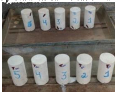
Figura 2 – Corpos de prova antes da imersão em lâmina de água de 5mm.
