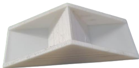
Figura 12. Protótipo inicial da balsa em PLA tratada com clorofórmio.
