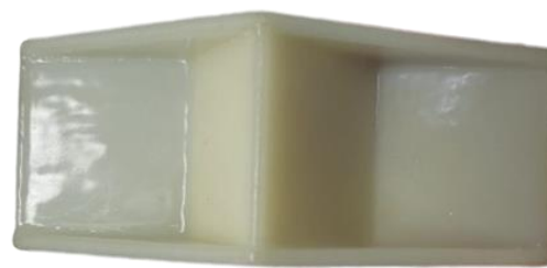
Figura 13. Balsa em ABS após o tratamento com acetona.
