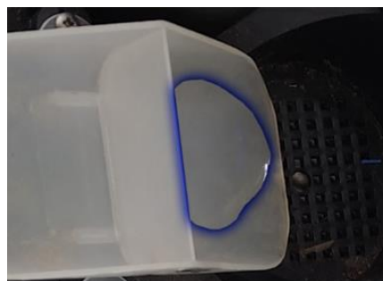
Figura 8. Pluviômetro aberto evidenciando retenção parcial da água durante o escoamento.
