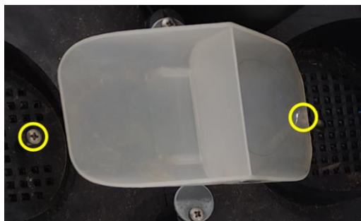
Figura 10. Pluviômetro aberto destacando parafusos de calibração.
