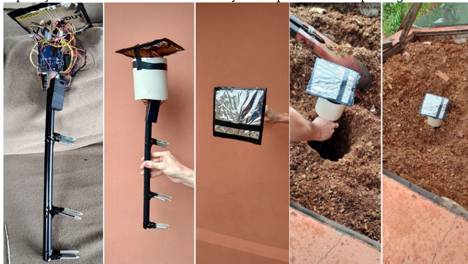
Figura 1. Disposição dos sensores e sua inserção na pilha de compostagem
