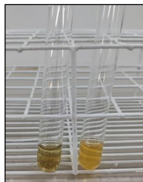
Figura 1. Íons \text{Fe}^{2+} e \text{Fe}^{3+} após a adição de NaOH.
