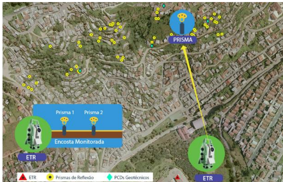
Figura 8. ETR monitorando taludes em encosta urbana
