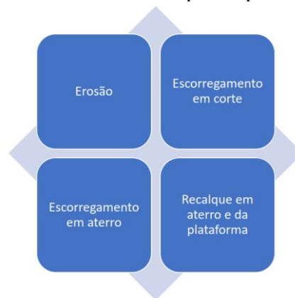
Figura 1. Problemas Geotécnicos mais comuns em Ferrovias
