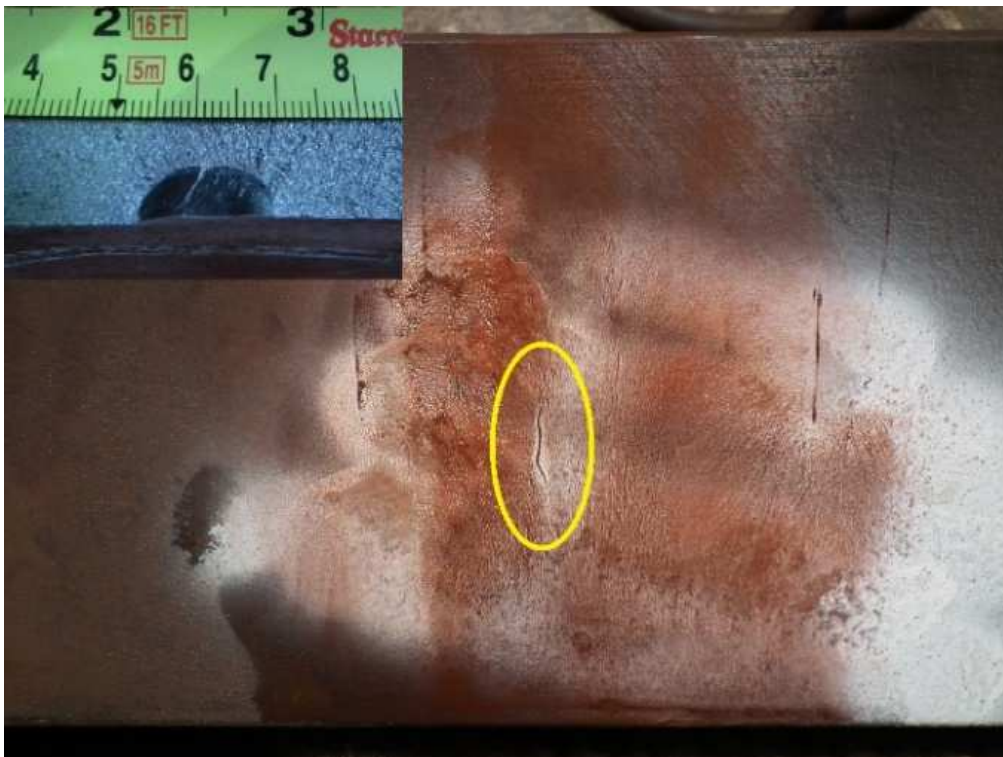
Figura 2 - Revelação do defeito no patim do trilho por líquido penetrante (Griffiths D., 2011)
