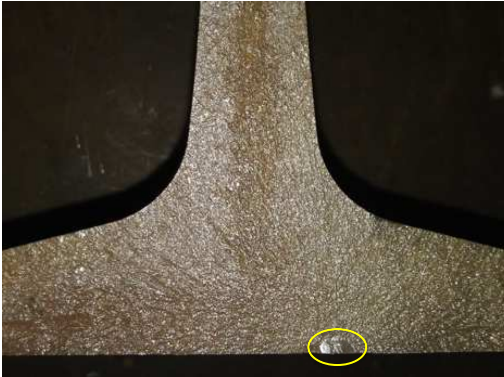
Figura 1 – Exemplo de ponto de inicialização de defeito transversal no patim do trilho causado por formação de martensita.
