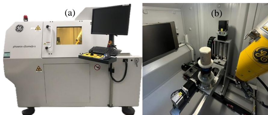
Figura 3: Microtomógrafo Phoenix v|tome|x|s (a) e esquema de como a amostra foi inserida para o imageamento (b).
