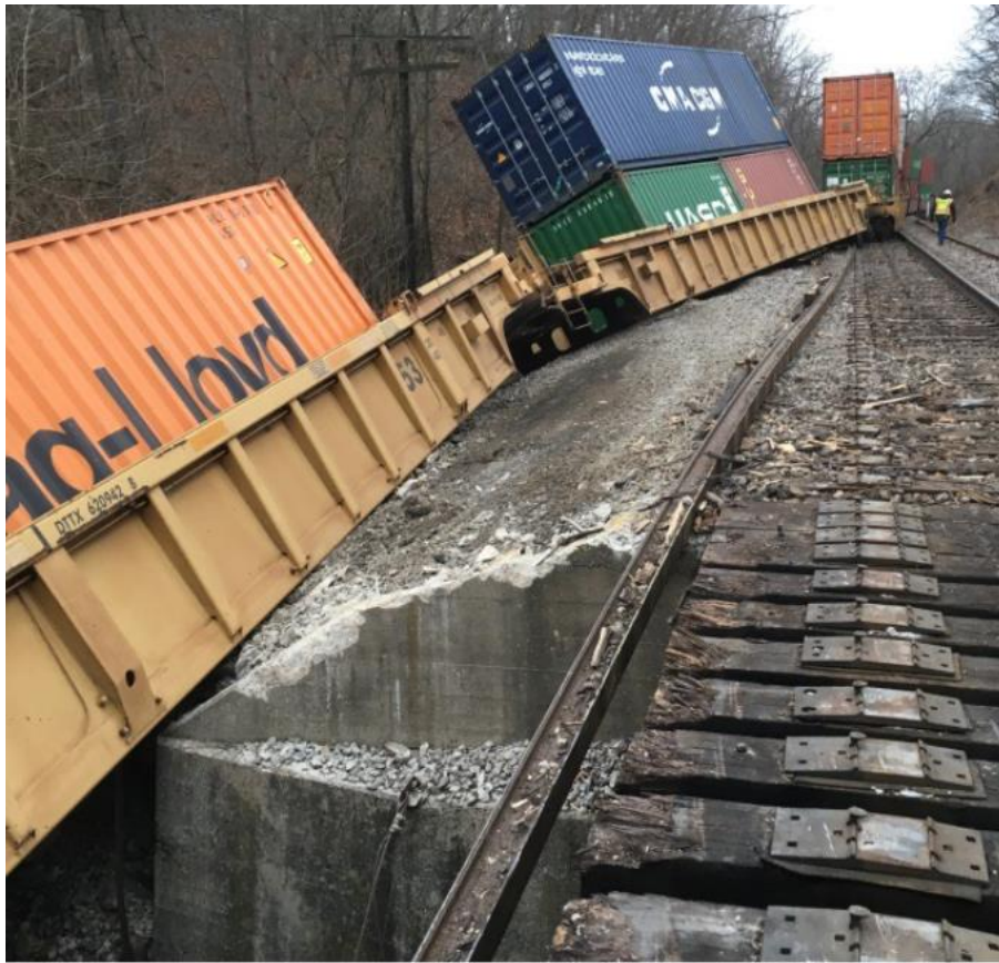
Figura 5. Acidente de quadramento de trilhos nos EUA, com desgaste hollow de rodas como causa contributória (KERCHOF, 2022).
