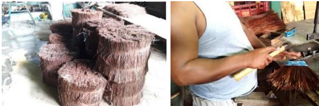
Figura 2: fibra de piaçava em fardos comercializados para produção de vassoura (a) e acabamento na produção de vassoura (b).
