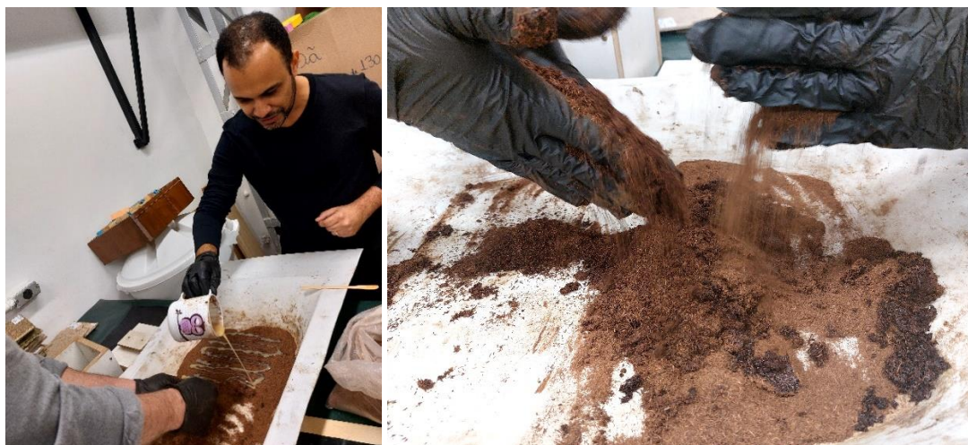
Figura 3: fibra de piaçava moída com adição de resina poliuretana a base do óleo de mamona (a) e mistura manual dos dois materiais (b).
