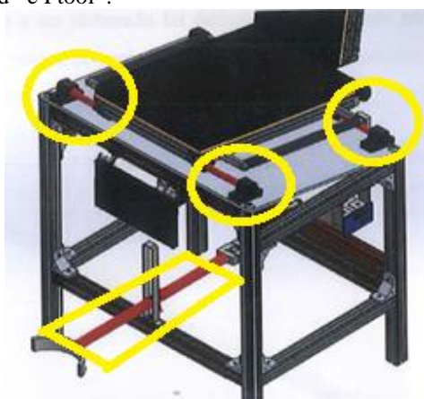
Figura 3: Pontos Críticos, destacados em vermelho, da Cadeira isométrica no TopSolid®
