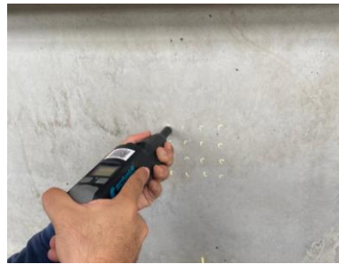
Fig. 1: Ensaio de esclerometria sendo realizado, Autores (2023)
