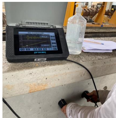
Fig. 2: Ensaio de velocidade de ultrassom sendo realizado, Autores (2023)
