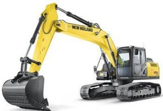
Figura 4 – Escavadeira New Holland - E405C EVO
