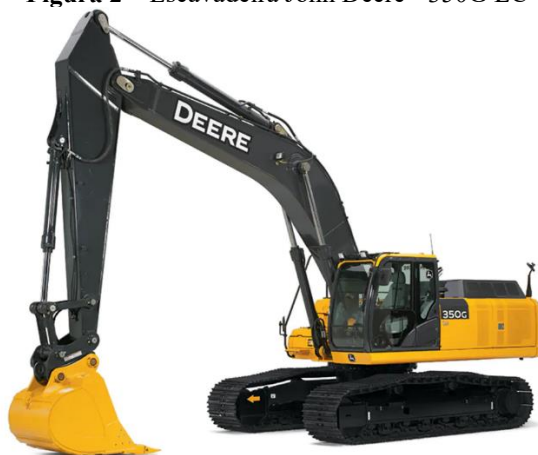
Figura 2 – Escavadeira John Deere - 350G LC
