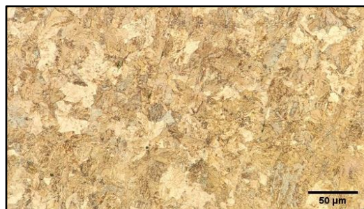
Fig 1: Micrografia da amostra do metal base após ataque químico com Nital 2%. Aumento de 200x. Fonte: (Autor).
