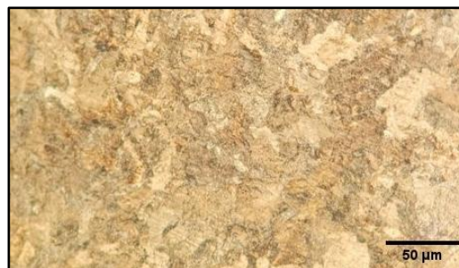
Fig 2: Micrografia da amostra do metal da ZAC após ataque químico com Nital 2%. Aumento de 200x. Fonte: (Autor).
