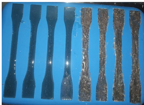
Figura 3 - Corpos de prova da matriz plena e dos compósitos.
