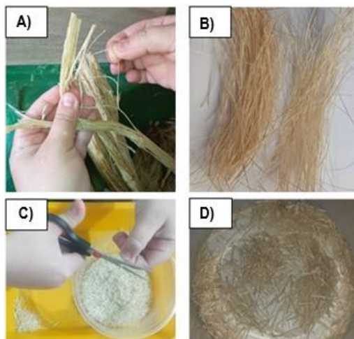
Figura 2 - Extração da fibra do bagaço da cana (a), a fibra extraída (b), a fibra sendo cortada (c) e a fibra já cortada (d).
