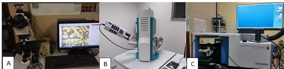
Figura 3 – A) Microscópio óptico, B) MEV, C) Espectrômetro Raman
