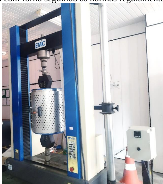
Fig. 1 – Máquina de Ensaio Universais EMIC DL – 1000 como forno resistivo acomplado.
