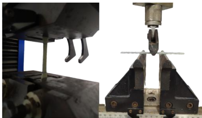
Fig. 4 – Ensaios de tração e flexão respectivamente no equipamento universal de ensaio EMIC 300 kN.
