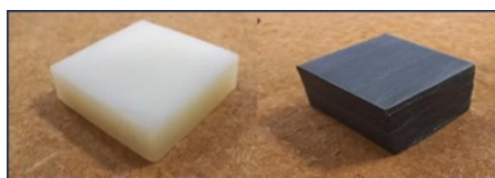
Fig.1 – Corpos-de-prova: PA66/6 (claro) e PA66/6-BM (escuro).
