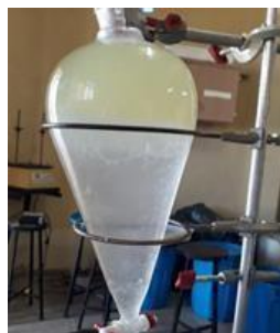
Figura 5: Lavagem aquosa do óleo residual.
