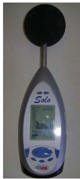
Figura 6: Medidor digital de Nível de Pressão Sonora (elaborado pelos autores).
