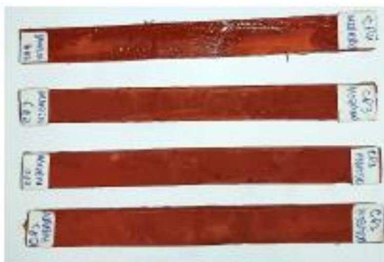
Fig. 1 – Corpos de prova híbridos (40% Lama vermelha e 5% de fibra de bambu).
