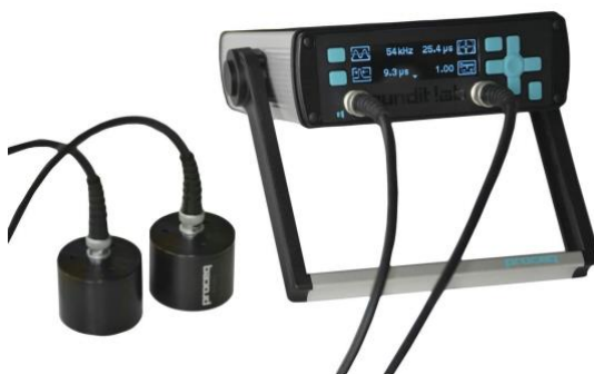
Figura 5 - Ultrassom modelo pundit lab
