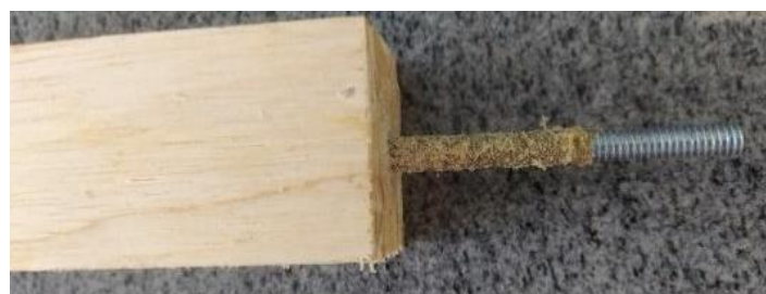
Figura 4: Modo de ruptura apresentado nos CPs das três séries.
