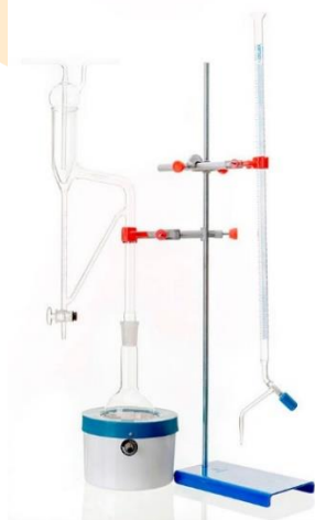
Figura 1: Sistema de extração de óleo essencial Clevenger
