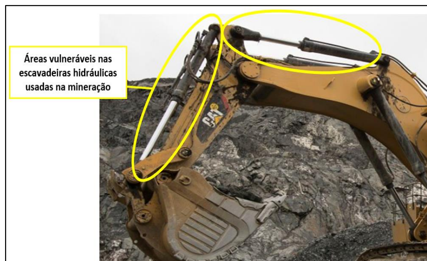
Figura 2. Áreas vulneráveis das escavadeiras de mineração
