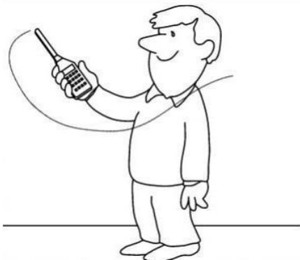
Figura 2: Exemplo de movimento do sonômetro. Fonte: ABNT NBR ISO 10052:2022
