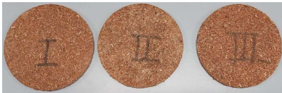
Figura 3: Amostra da fibra de madeira misturada com poliuretano com polioli de mamona (Bittencourt, 2023)
