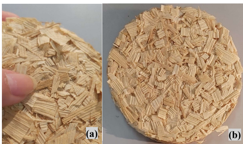
(a) Amostra de fibra de milho com bolor, Figura 1 (a). (b) Amostra de fibra de milho, Figura 1 (b).
