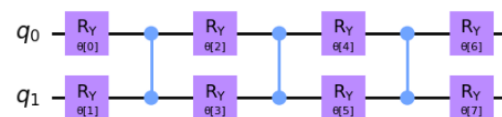
Figura 1. Circuito quântico representando o ansatz denominado por Two-Local , que pertence à classe de ansatz eficientes da biblioteca da Qiskit.
