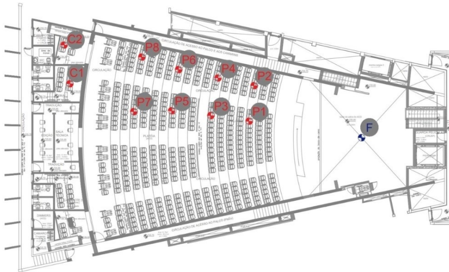
Figura 1: Localização do posicionamento dos pontos de fonte sonora (em azul) e de receptores (em vermelho) utilizados na sala
