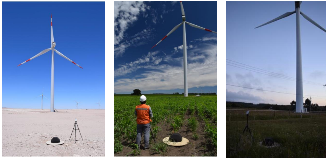
Figura 6: Medição de ruído de aerogerador utilizando o sonômetro fabricado pela Cesva de modelo SC310 em parques eólicos no Chile (retirado de Rodenbeek et al. [6]).
