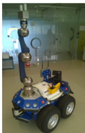
Figura 3 - Robô usado para o carregamento dos furos com explosivos (Ferreira et al. , 2017).
