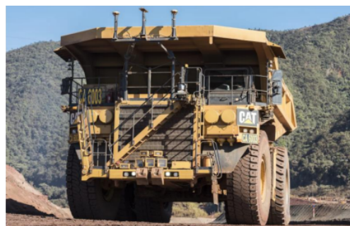
Figura 6 - Caminhão autônomo da mina de Brucutu em Minas Gerais (Vale, 2018).
