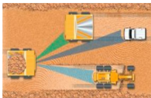
Figura 4 - Sistema de detecção de obstáculos (Rivera, 2014).
