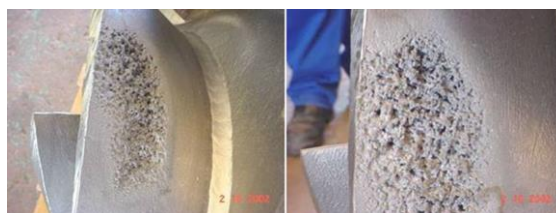
Figura 5. Rotores em aço inoxidável 316 danificados por cavitação (Dow Brasil, 2002).
