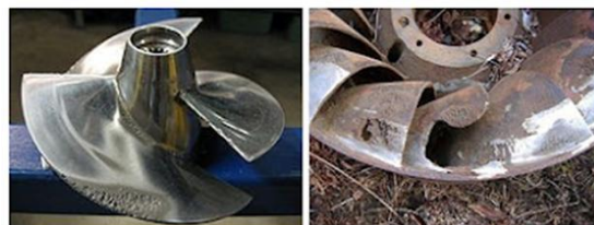
Figura 4. Rotores de turbinas danificados por cavitação (Camargo, 2018).
