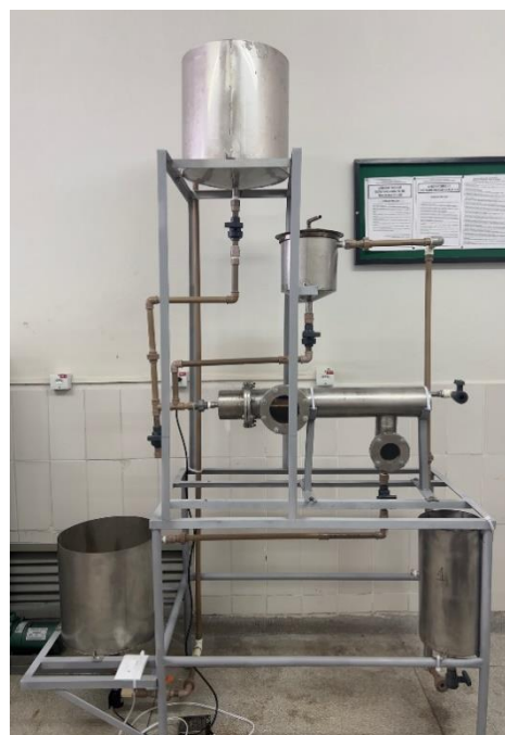
Figura 3. Fotografia do protótipo de bancada contendo o decantador contínuo com camada líquida coalescente instalado na Unicap-ICAM TECH
