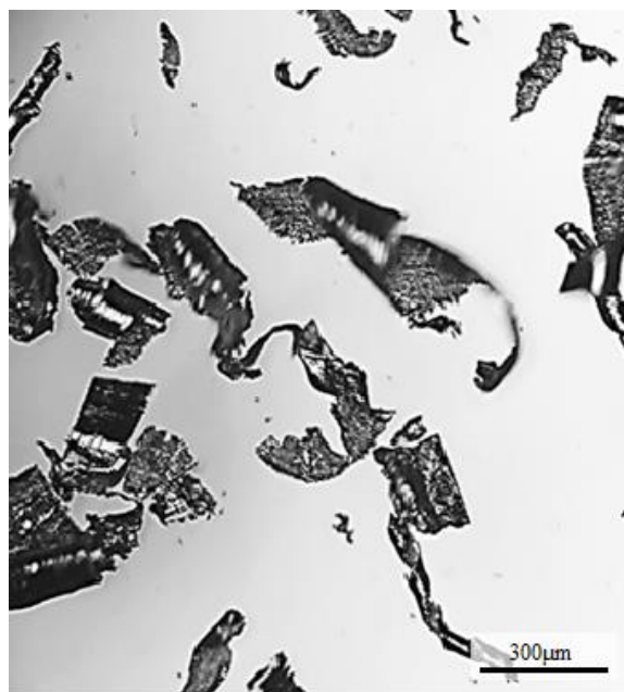
Figura 2. Cavacos de magnésio obtidos pela técnica de microscopia óptica.
