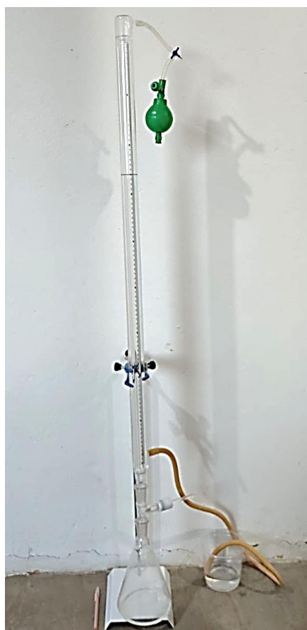
Figura 1. Vidraria projetada para medição de volume da reação
