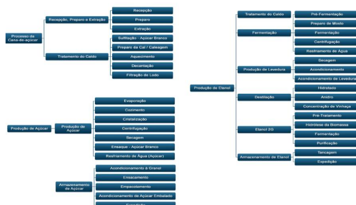
Figura 1 – Estrutura do processamento industrial de cana-de-açúcar para produção de açúcar e etanol.
