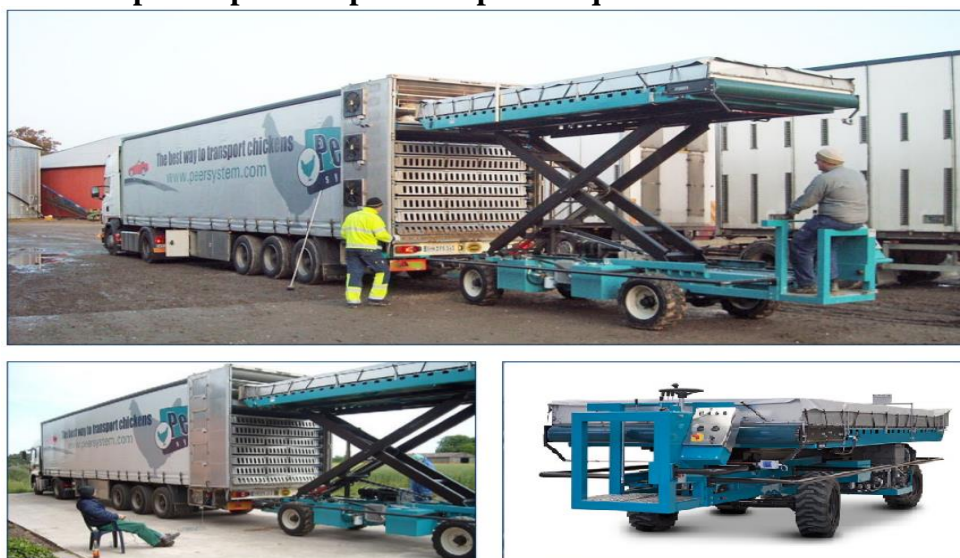
Figura 2: Shuttle – Equipamento utilizado para movimentação e carregamento das aves no trailer de transporte após ser apanhado pela máquina no interior do aviário
