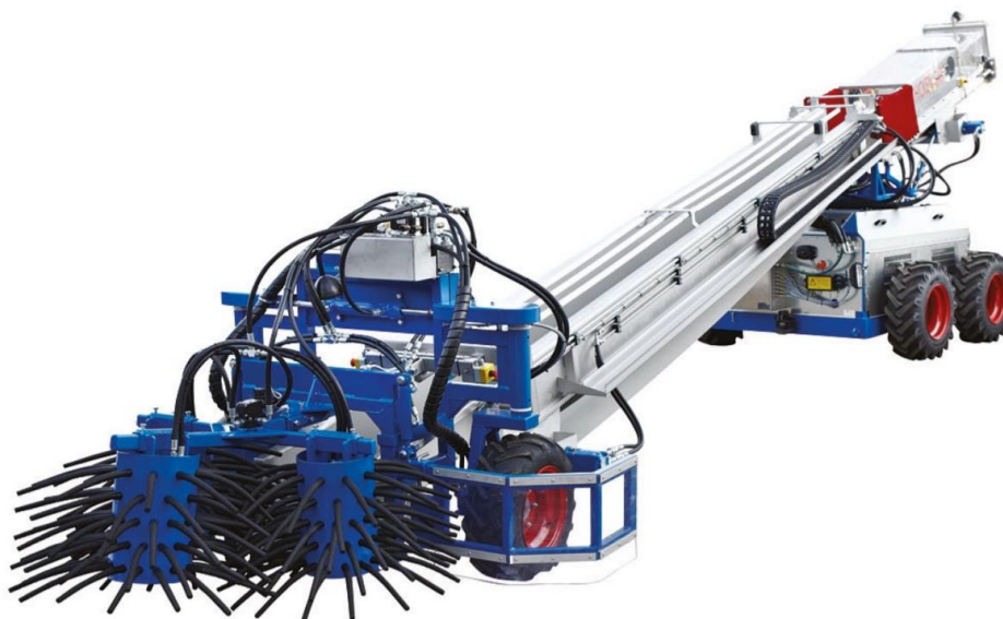
Figura 1: Máquina utilizada para fazer a apanha automatizada das aves no interior do aviário
