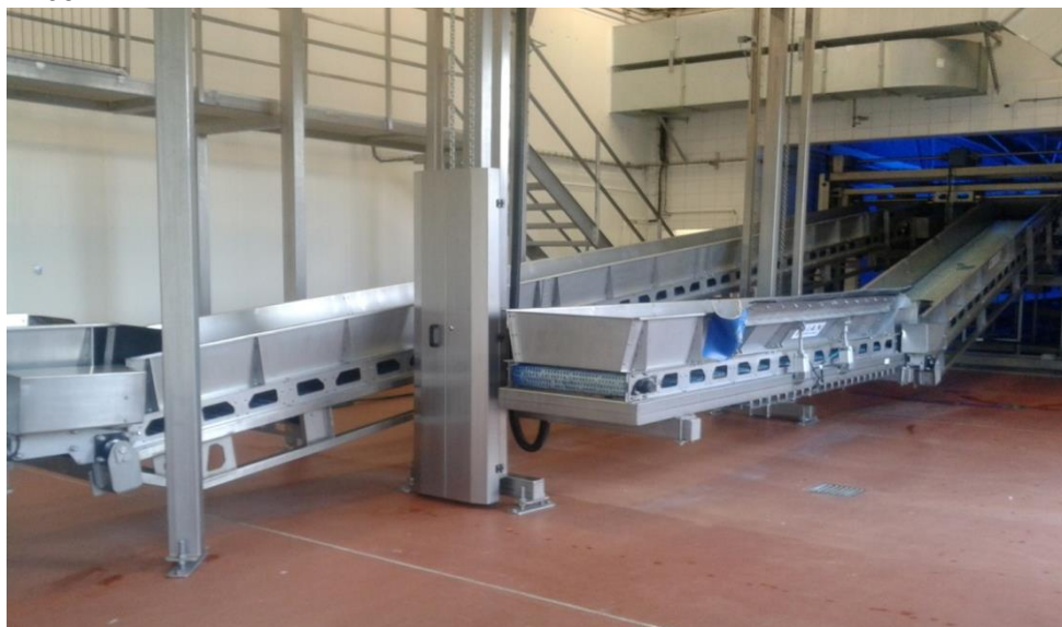
Figura 4: Equipamento utilizado para desembarque automático de aves após a chegada no frigorífico
