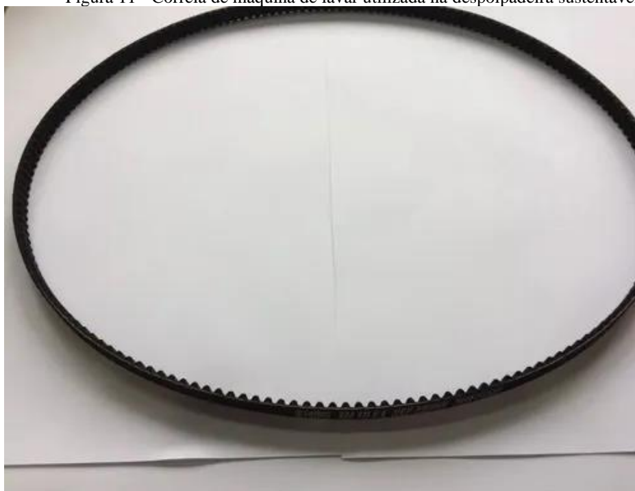
Figura 11 - Correia de máquina de lavar utilizada na despulpadeira sustentável.
