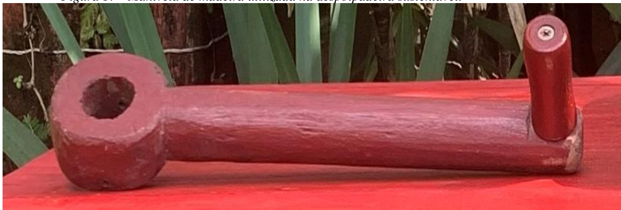
Figura 17 - Manivela de madeira utilizada na despulpadeira sustentável.
