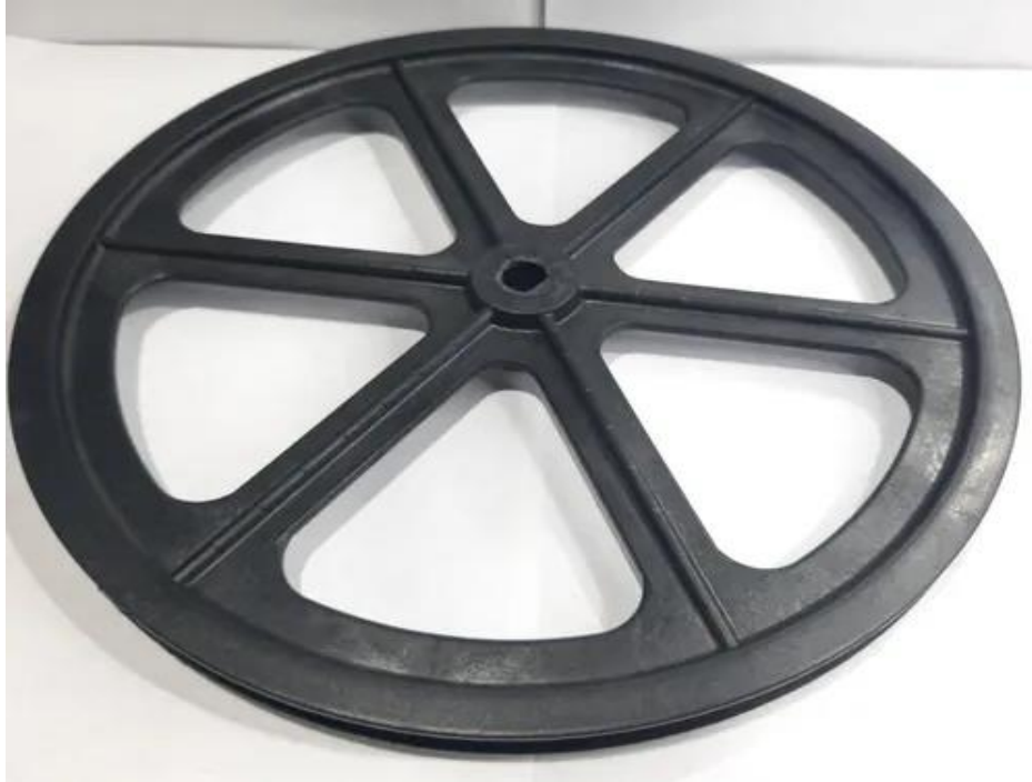
Figura 12 - Polia de máquina de lavar utilizada na despolpadeira sustentável.
