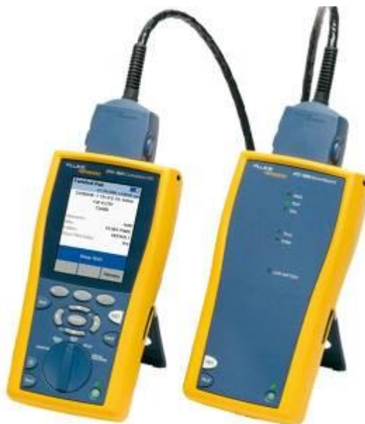
Figura 4 – Certificador de cabos de par trançado
