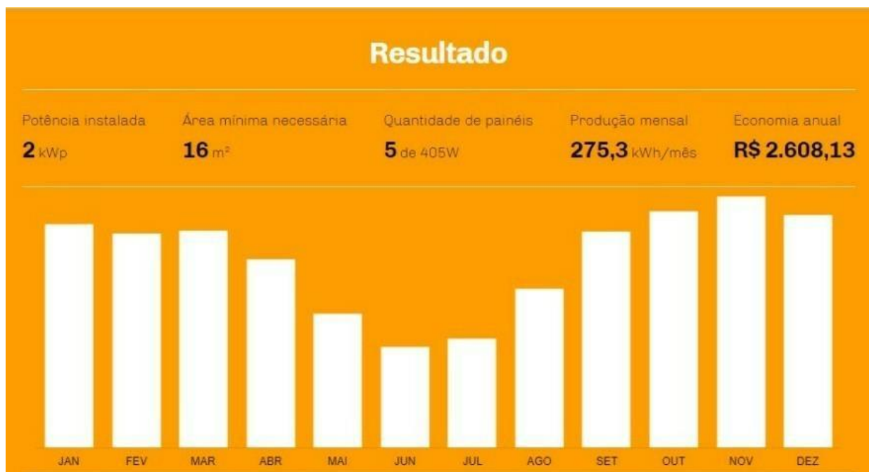
Figura 2. Simulador do portal solar com os dados da residência localizada em Sumé-PB
