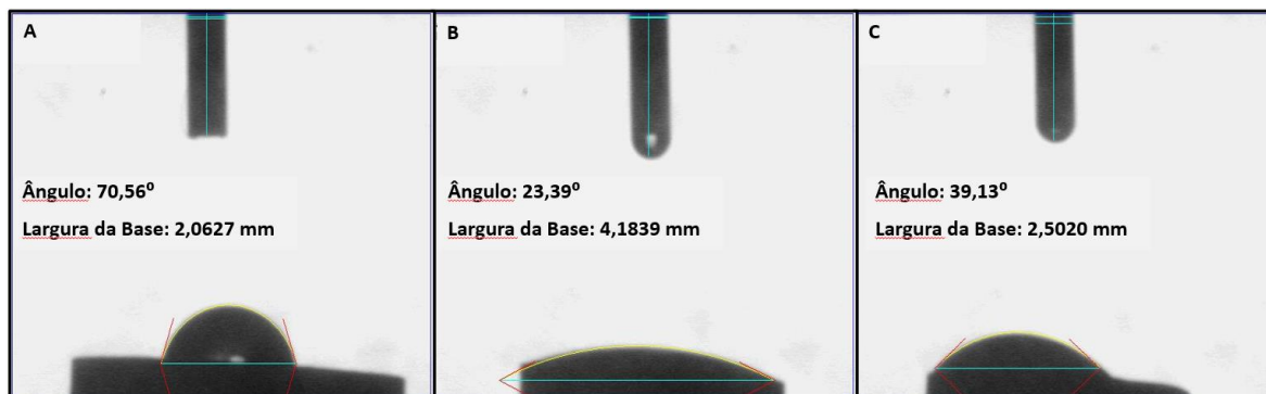
Figura 10: Molhabilidade das amostras dos subgrupos A 1 (A), A 2 (B) e A 3 (C).
