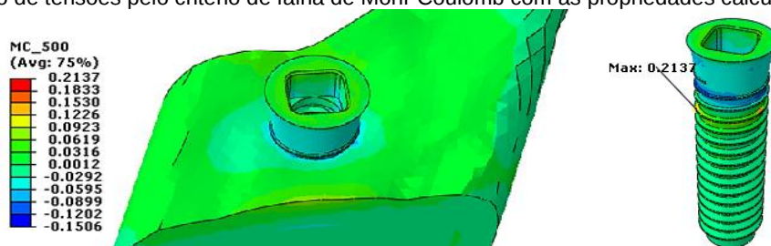
Figura 2 – Distribuição de tensões pelo critério de falha de Mohr Coulomb com as propriedades calculadas para 80 anos.
