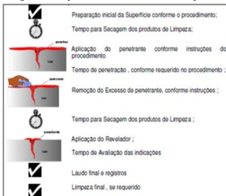
Figura 7 – Sequência de atividades do ensaio por LP
